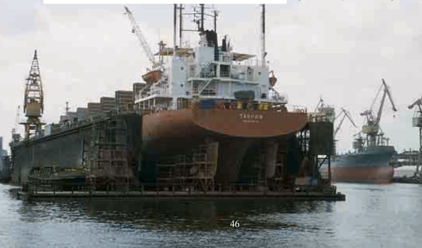
Niżej: amerykański statek TARPON – wymiana 35 t stali i ponad 200 m rur systemu załadunkowego (2002 rok)
