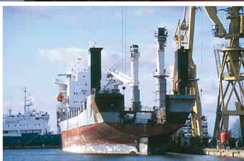
Niżej: amerykański statek TARPON – wymiana 35 t stali i ponad 200 m rur systemu załadunkowego (2002 rok)
